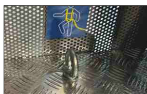
Punto di ancoraggio per D.P.I. anti-caduta sul cestello
