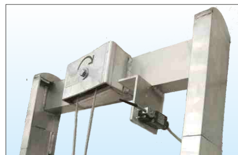
Elemento di testata con carrucola di rinvio fune anti-detensionamento
