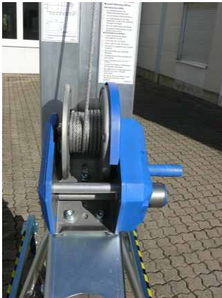
Avvolgimento corretto della fune di acciaio sul tamburo della fune
