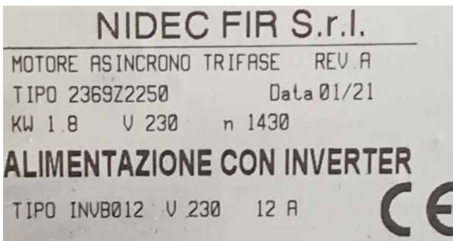
FIGURA 2: TARGA RIPORTANTE LE CARATTERISTICHE DEL MOTORE ELETTRICO
