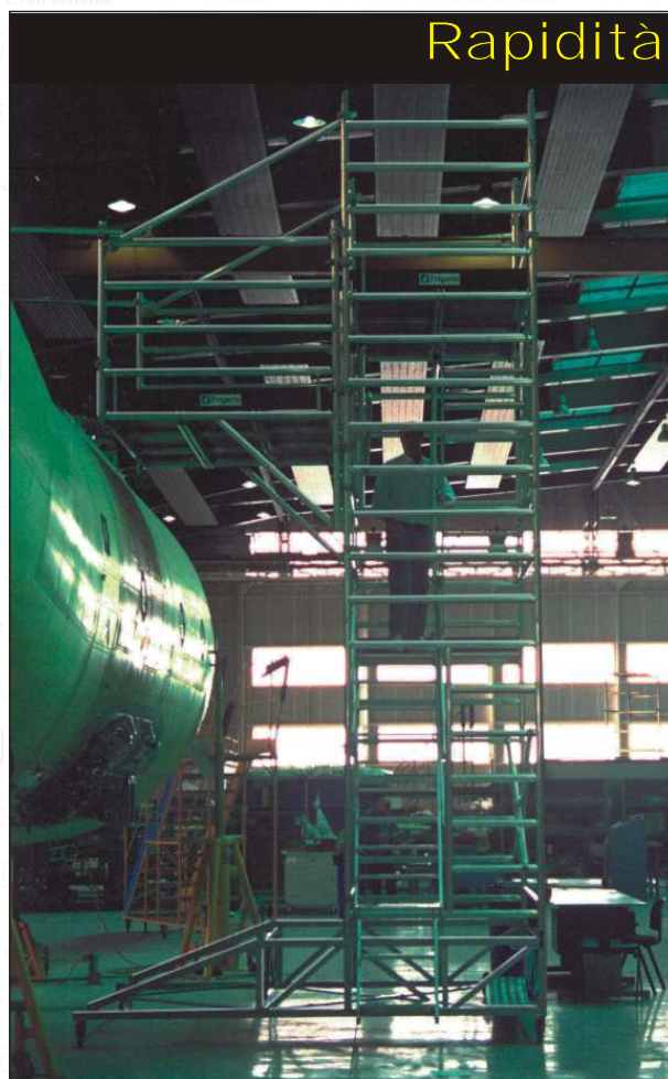
Piattaforma a sbalzo per lavorazione fusoliera C27
