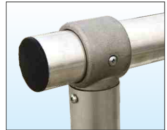
Parapetto realizzato in tubo Ø 50 mm con giunzioni in fusione di alluminio anti-ruggine fisse o snodabili per consentire cambi di direzione e di quota.
