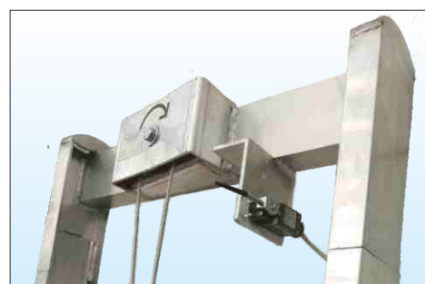
Elemento di testata con carrucola di rinvio fune anti-detensionamento
