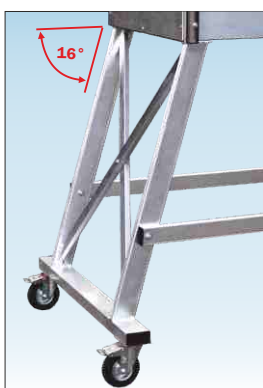
Cavalletto di sostegno inclinato per conformità a norma europea EN131-7 senza zavorra aggiuntiva Molto robusto e in posizione inclinata per garantire la sicurezza anti-ribaltamento secondo quanto previsto dalla normativa europea EN131-7
