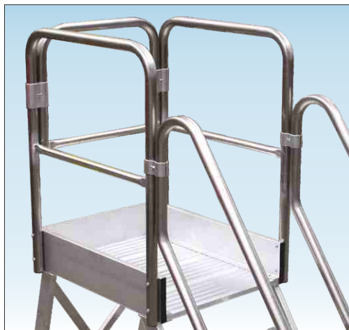
Grande piattaforma di lavoro regolamentare Realizzata 100% in alluminio anti-ruggine con dimensioni 600 x 600 mm. dotata di parapetto alto mt. 1 realizzato in tubo tondo Ø 42 mm. e di fermapiede alto 150 mm.
