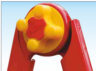
Cerniera a dischi dentati realizzata in acciaio verniciato con serraggio manuale mediante pomello a vite realizzato in plastica rinforzata
