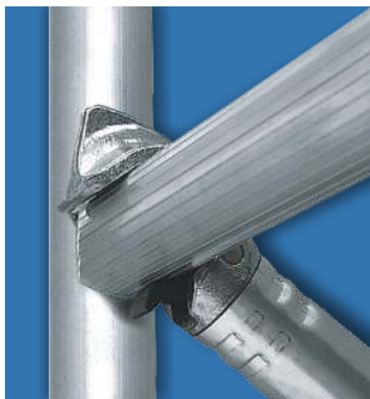
Particolare del nottolino di sicurezza che, una volta avvenuto l'aggancio automatico della manina al montante, ne impedisce il distacco accidentale.
